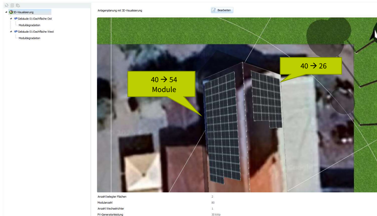
Abbildung 8: Darstellung der modifizierten PV-Anlage in PV*Sol. Von den 40 Modulen auf der Ostseite sind 14 Module auf die Westseite verlegt worden.
