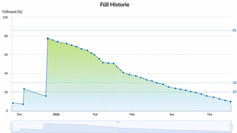
Abbildung 16 Füllstand Tank über Zeit – RTC Messtechnik – Level View [12]
